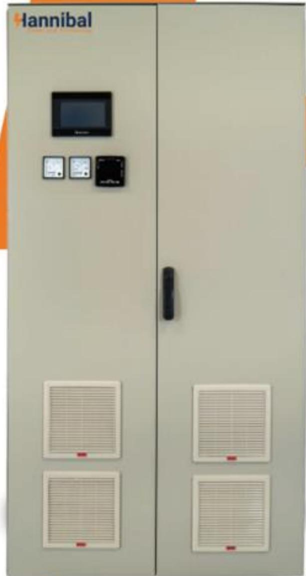
Los Reguladores de Tensión Servo de Hannibal están compuestos por un autotransformador toroidal tipo Variac (“transformador variable”), un transformador elevador (booster), un motor servo y un circuito de control basado en microprocesador.
