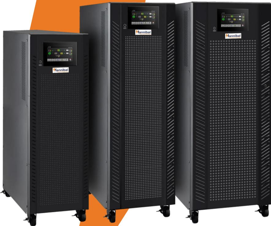
La Serie PLMT 10–80 kVA es un UPS online trifásico de alto rendimiento que utiliza tecnología DSP y rectificación IGBT de 3 niveles para aplicaciones industriales y de gran escala. Con verdadera doble conversión y bypass dividido, garantiza tiempo de transferencia cero y salida senoidal pura (PF 1.0), asegurando que los sistemas críticos permanezcan operativos.
